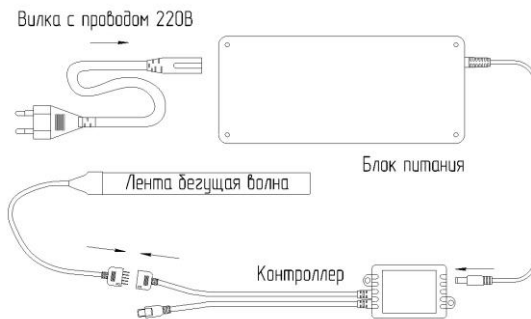
Рисунок 3– Схема подключения контроллера, светодиодной ленты и блока питания.
